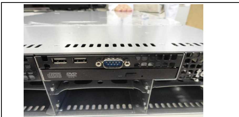
Figura 4 - Detalhe da placa de interface e unidade de DVD
